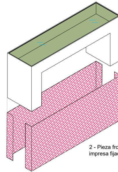
2 - Pieza frontal de tela impresa fijada con velcro.
