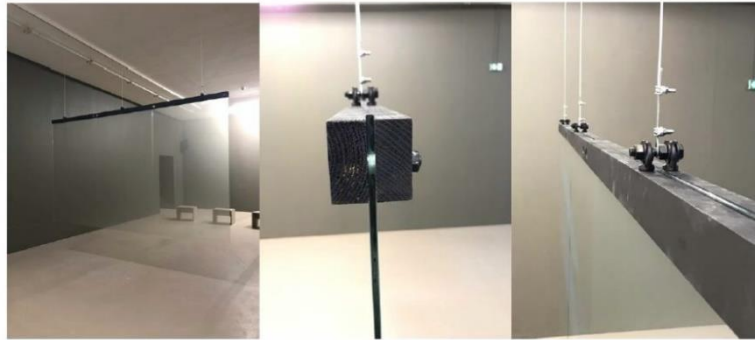
Pantalla holográfica producida por el IAC, compuesta por 3 paneles de cristal (1066x1880 mm cada cristal/ Peso total 93kg).
